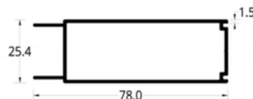
2536 TUBULAR PUERTA ENTAMBORADA (78 X 25.4) mm. ESPESOR 1.5 mm.
