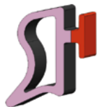
EMPAQUE BURBUJA SELLO INTERIOR/EXTERIOR PARA MARCO/NAVE BOREAL/SIDERAL/TAIRONA/ZINU EMB 03MN
